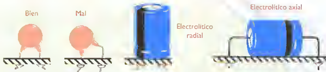
Figura 6.10. Montaje de los condensadores
